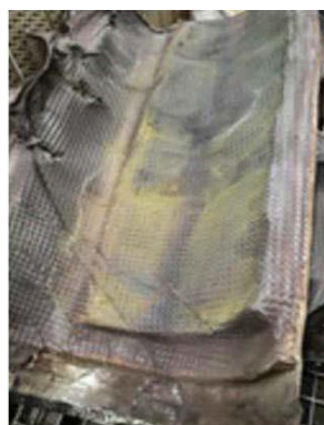
Production de poussière jaune sous pièce isolante
