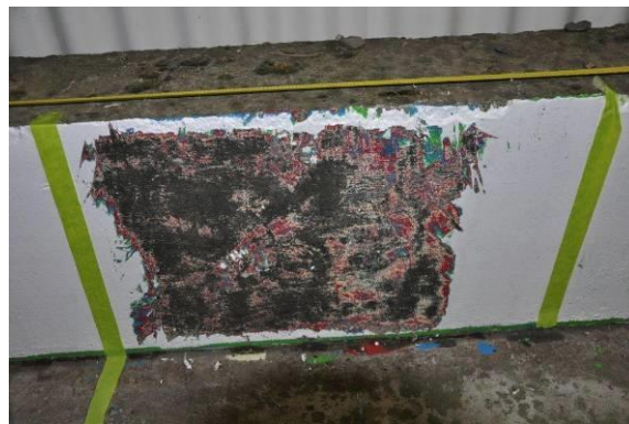
Testmuur afbijten dispersieverf
